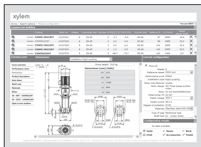
Ölçümlü çizimler ekranда görüntülenir ve dxf biçiminde indirilebilir.
